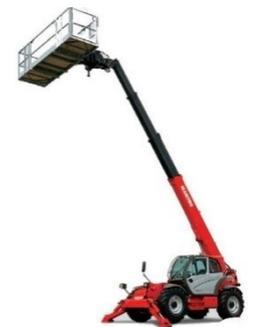
Bild 3: Multifunktionsgerät mit schwenkbarem Arbeitskorb und geeigneten Zugangstüren
